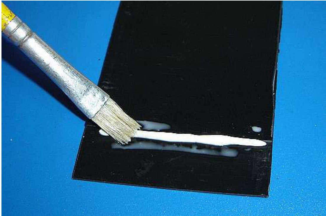
Figura 13 - Massa sendo alisada, após a aplicação sobre a chapa
